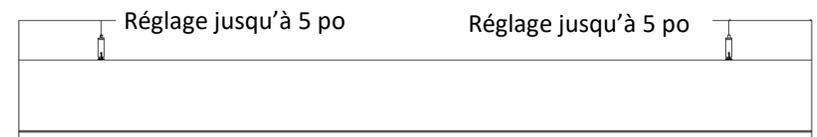
Le montage se règle jusqu'à 5 po de chaque extrémité du (des) module(s).
