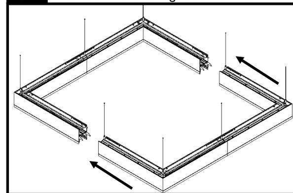
Si vous installez une configuration fermée carrée ou rectangulaire, il est recommandé d'installer d'abord les luminaires en forme de U/coins et de compléter l'installation en rassemblant les sections en U tel qu'illustré.
