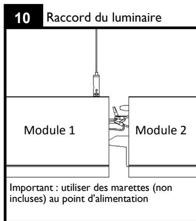
Joindre les modules et enclencher les raccords d'alignement du module 2 sur le support du luminaire du module 1. Les modules des luminaires se supportant, compléter les connexions de filage entre les modules.
