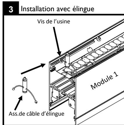
Le module 1 au plancher, glisser l'assemblage de câble d'élingue dans la chasse de la vis sur le dessus du luminaire à chaque extrémité.
