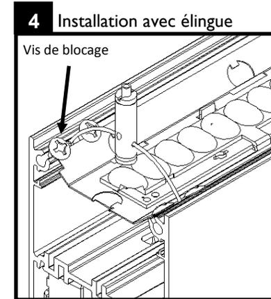
Visser les vis à tête no 8 pour rattacher les assemblages d'élingue au boîtier pendant le processus d'assemblage.
