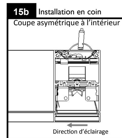
Le dessin ci-dessus illustre une coupe en coin asymétrique vers l'intérieur d'un éclairage direct/indirect. Ce coin dirige toute la lumière vers le bas vers l'intérieur du coin. Vous référer aux dessins de configurations fournis pour l'orientation du coin (direction de l'éclairage) et l'emplacement de montage adéquats.
