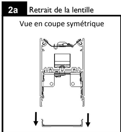
Retirer la lentille du luminaire et la mettre de côté jusqu'à la fin de l'installation. Utiliser des gants de coton pour manipuler la lentille et la déposer dans un endroit propre. **Note** : Ne pas mélanger les lentilles symétriques et asymétriques puisqu'elles sont différentes.
