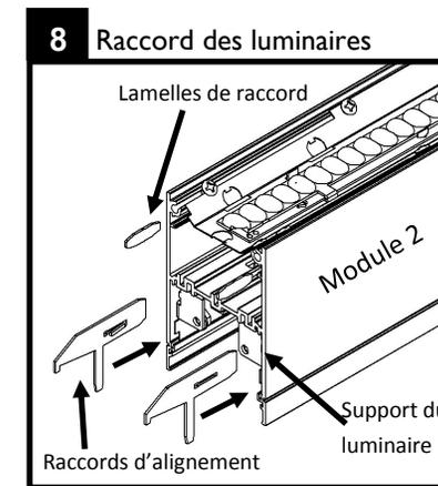
Le module 2 sur le plancher, piquer les lamelles de raccord dans la chasse de vis à l'intérieur supérieur. Vous assurer que plus de la moitié des lamelles de raccord soient insérées à l'intérieur du luminaire. Insérer les raccords d'alignement dans la chasse de vis à l'intérieur inférieur tel qu'illustré. Vous assurer que l'orientation permettra l'insertion de la languette de verrouillage à l'intérieur du support du luminaire.
