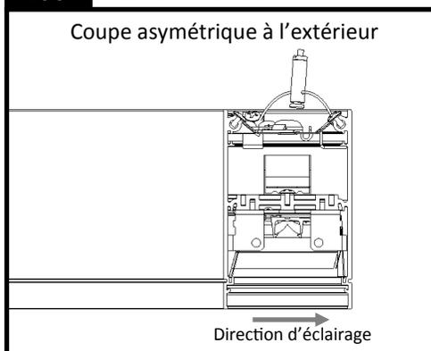
Le dessin ci-dessus illustre une coupe en coin asymétrique de l'extérieur d'un coin. Ce coin dirige toute la lumière vers le bas vers l'extérieur du coin. Vous référer aux dessins de configurations fournis pour l'orientation du coin (direction de l'éclairage) et l'emplacement de montage adéquats.
