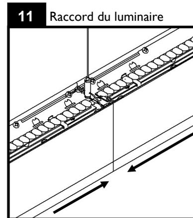
Vous assurer que toutes les connexions sont bien rattachées et que tous les fils sont rentrés dans la cavité du luminaire. Rapprocher doucement les luminaires ensemble.
