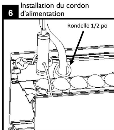
Choisir l'emplacement de l'alimentation et percer l'entrée défonçable de 1/2 po à l'extrémité désirée. Installer la rondelle de 1/2 po à l'intérieur du luminaire tel qu'illustré. Acheminer le cordon d'alimentation dans la cavité de filage du luminaire.
