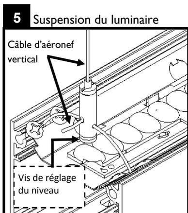
Soulever le luminaire au niveau d'installation et insérer le câble d'aéronef vertical dans l'assemblage de câble d'élingue. Vous assurer que le câble d'aéronef sort de l'assemblage de câble d'élingue tel qu'illustré.
