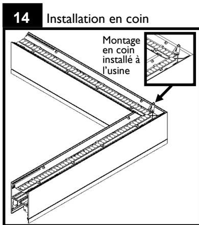
Si un coin est requis, il est recommandé d'installer d'abord le module en coin de 2piX2pi. Tous les coins incluent un assemblage de câble d'élingue au milieu. Vous référer aux dessins de configuration d'enfilades en coin et aux figures 15a, 15b et 15c pour l'emplacement et l'orientation du coin adéquats.
