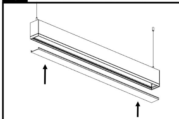
Installer les lentilles retirées à l'étape 1 en les enclenchant à l'intérieur de l'extrusion du boîtier. Conseil : pour une installation plus facile, débiter à une extrémité du boîtier ou à un joint en comprimant légèrement la lentille sur les deux côtés tout en la guidant à l'intérieur du boîtier.
