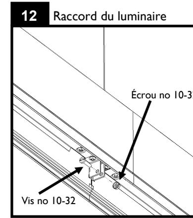
Rattacher les modules de luminaires ensemble à l'aide des deux vis mécaniques no 10-32 et des deux écrous no 10-32 inclus. Resserrer jusqu'à ce que le joint soit bien serré. **Note : Ne pas trop serrer.**
