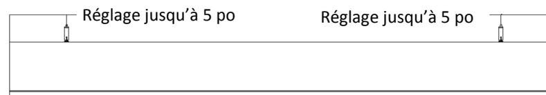
Le montage se règle jusqu'à 5 po de chaque extrémité du (des) module(s).
