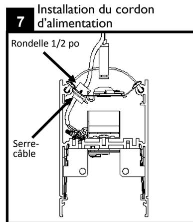
Installer et pincer la rondelle serre-câble de métal pour rattacher le cordon d'alimentation sous le réflecteur du luminaire. Utiliser l'outil de sertissage Heyco PN0019(R12) pour obtenir une installation adéquate. Si vous n'installez qu'un seul luminaire vous rendre à l'étape 13.
