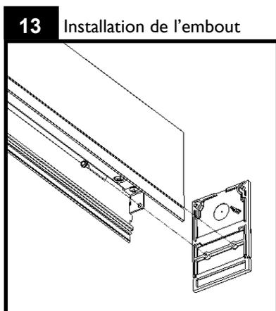
Glisser l'embout dans l'extrémité du module de luminaire et rattacher par-dessous à l'aide des deux vis no 8-32 X 5/16 po. Vous assurer que l'excédent de fil d'aéronof ne nuit pas à rattacher l'embout. Serrer les vis jusqu'à ce que le joint soit serré. **Note : Ne pas trop serrer.**
